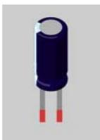
電解コンデンサです。容量はパッケージに印刷されています。
