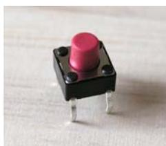
押すと ON になって 放すと OFF になるスイッチです。方向によってスイッチ内部の結線が異なりますので注意してください。写真手前 2 ピン間がスイッチ操作時に ON → OFF に切り替わります。
